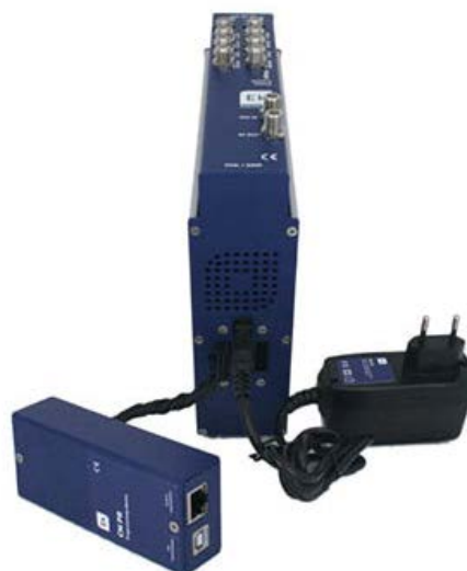
Figura 4. Conexión del módulo a fuente
